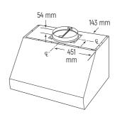
Nella figura sono riportate le dimensioni per lo scarico verticale, fondamentali per la corretta installazione.
